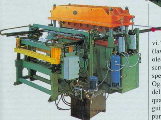
**Un impianto automatico di tranciatura composto da una pressa meccanica da 200 t e transfert a posizionamento elettronico per il carico e lo scarico di fogli con dimensioni di 600 x 2.000 mm.**
