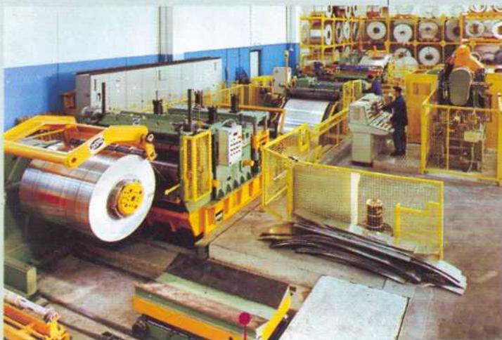
**Linee di taglio longitudinale modello TOP realizzata da Faspar.**
