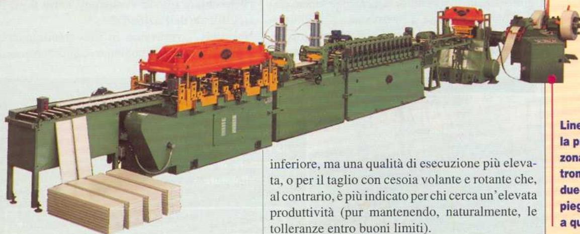
**Linea automatica Faspar per la produzione di ripiani con zona di tranciatura e troncatura con pressa a due colonne, profilatrice e piegatura totale con pressa a quattro colonne.**
