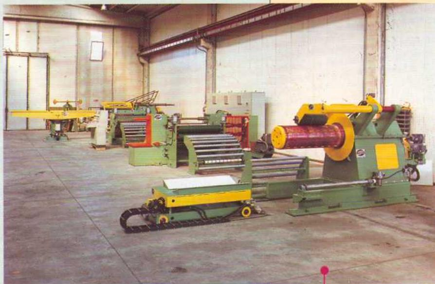
**Linea "slitter" modello ECO realizzata da Faspar per coil con larghezza di 1.600 mm con spessore da 0,5 a 2,5 mm di acciaio inox e normale.**
