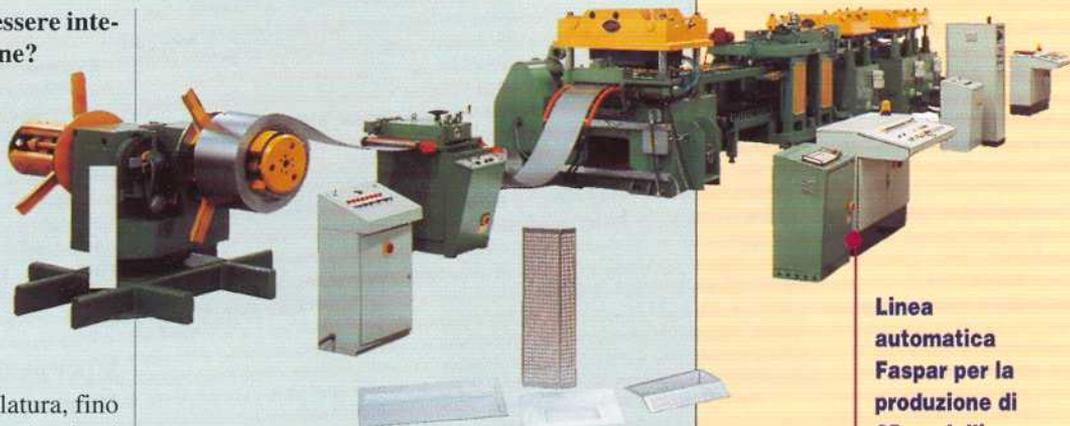
**Linea automatica Faspar per la produzione di 25 modelli differenti di griglie con presse meccaniche tipo FP.**
