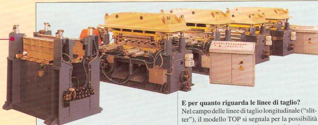
grazie alla programmazione elettronica è stata una linea automatica per la produzione di fianchi e testate per armadi elettrici, di cui era appunto in grado di produrre 10 versioni differenti.
