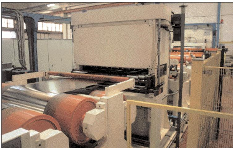
**Il sistema di spianatura in tensione alla Italpack.**
