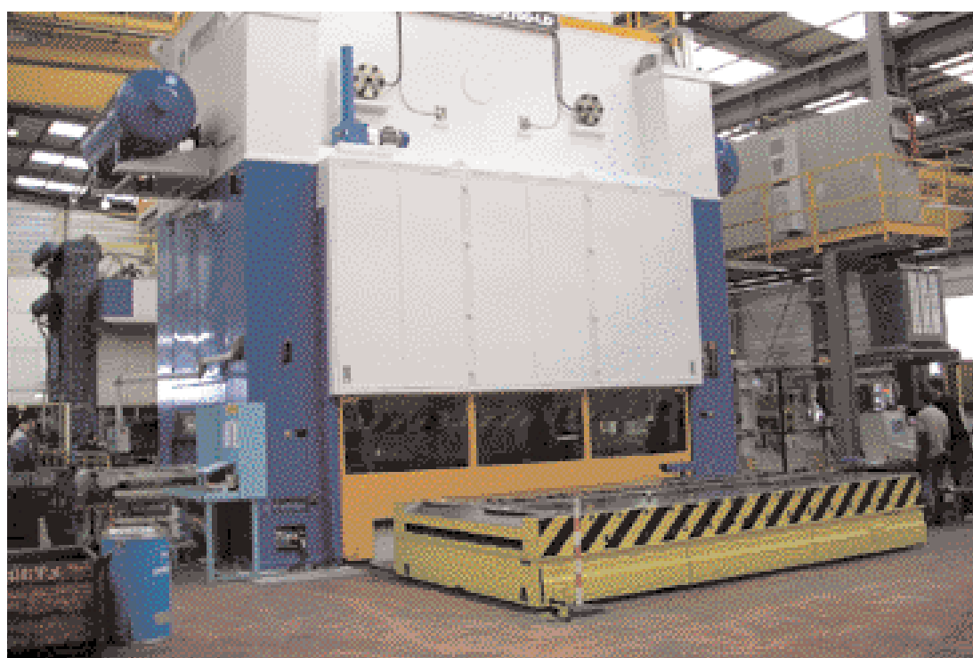
Fig. 3 La grande pressa di 1500 t per 5000 mm di luce libera: si noti il carrello porta stampi predisposto per il cambio automatico stampo al cambio di produzione.
