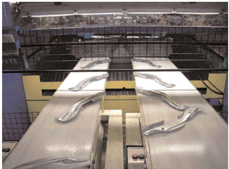
Fig. 7 Produzione di un altro tipo di pezzo sulla nuova linea: si tratta di un componente strutturale per carrozzeria prodotto in due esemplari (destra e sinistra) ad ogni colpo.
