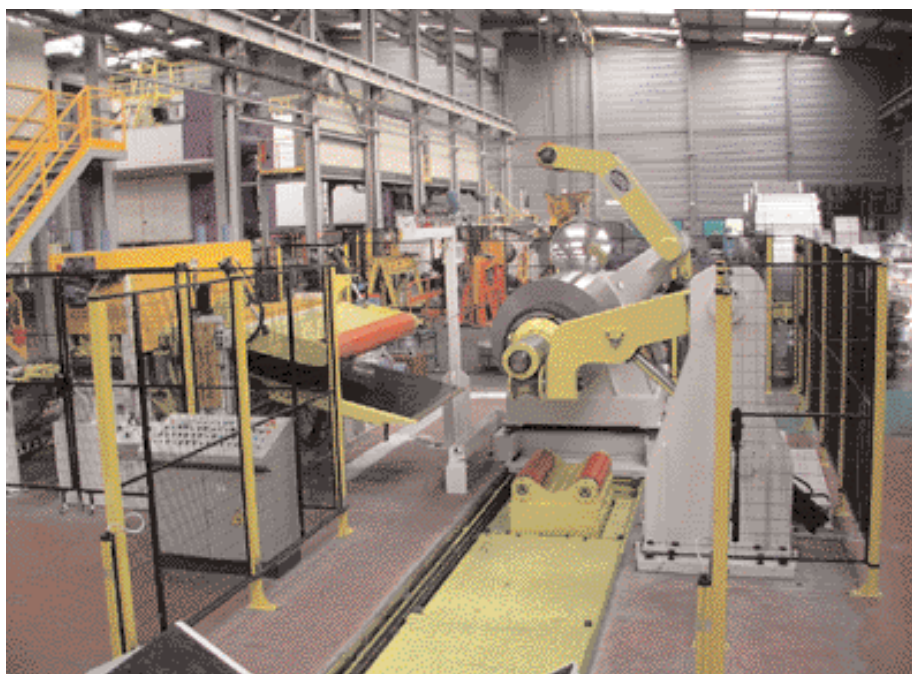
Fig. 2 La culla di carico (in primo piano) e l'aspo svolgitoro della nuova linea.
