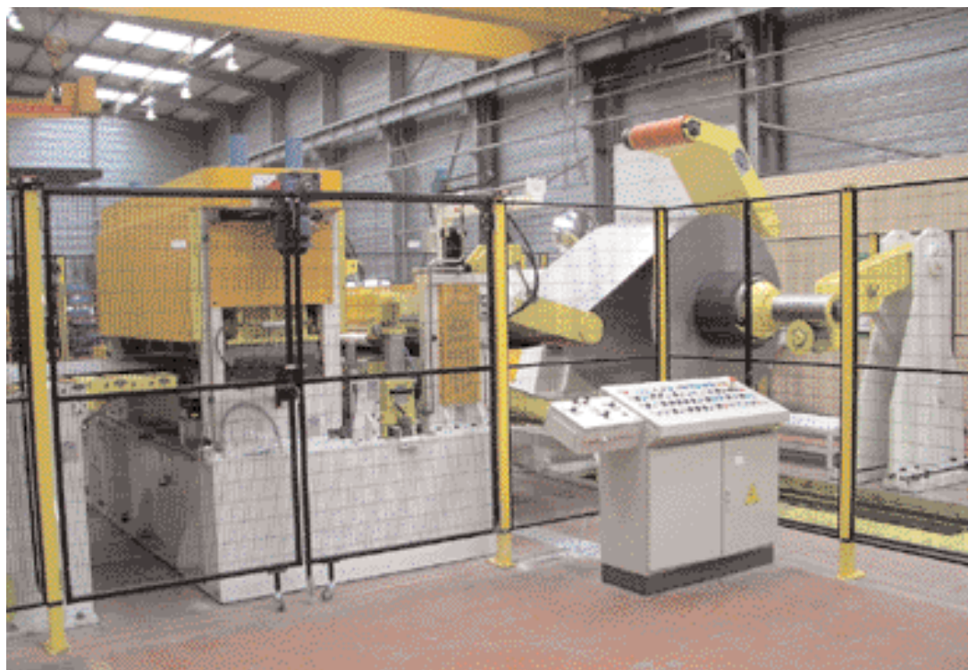
Fig. 4 Il pulpito di controllo del cambio coil.
