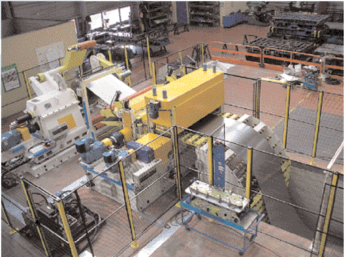
Fig. 1 Panoramica della zona di alimentazione della nuova linea di stampaggio: si vedono a destra la sella di stoccaggio, la culla di carico coil sotto l'aspo svolgitore e l'aspo stesso, il pinch roll di introduzione, la raddrizzatrice-spianatrice e l'ansa di compensazione.
