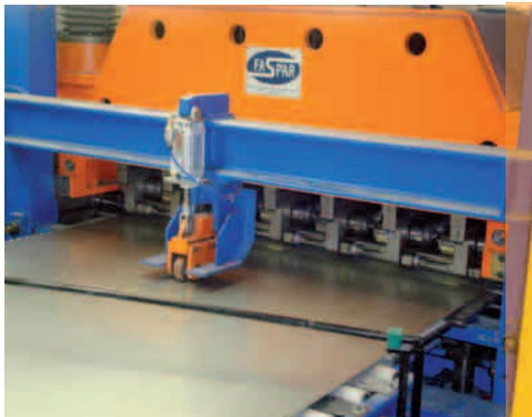
**An der Richt- und Abkantanlage hat Faspar die Richtmaschine optimiert, damit die erzeugte Glätte den Qualitätsanforderungen entspricht.**
