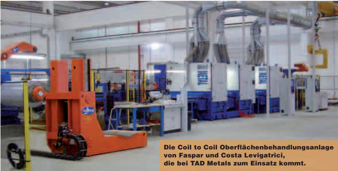
Die Coil to Coil Oberflächenbehandlungsanlage von Faspar und Costa Levigatrici, die bei TAD Metals zum Einsatz kommt.
