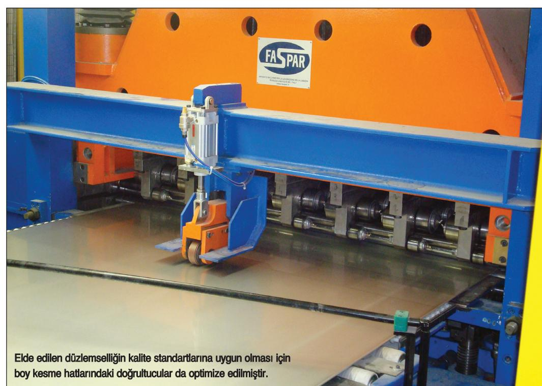
Elde edilen düzlemselliğin kalite standartlarına uygun olması için boy kesme hatlarındaki doğrultucular da optimize edilmiştir.
