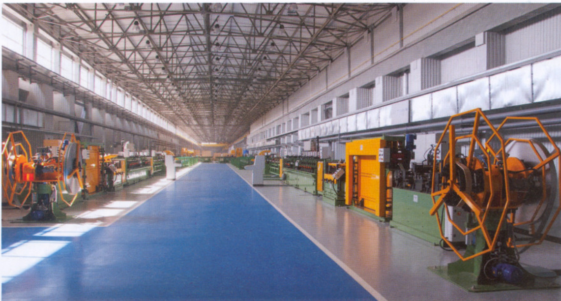
Le due linee tubo gemelle Olympia80, installate nella fabbrica in Ucraina.
